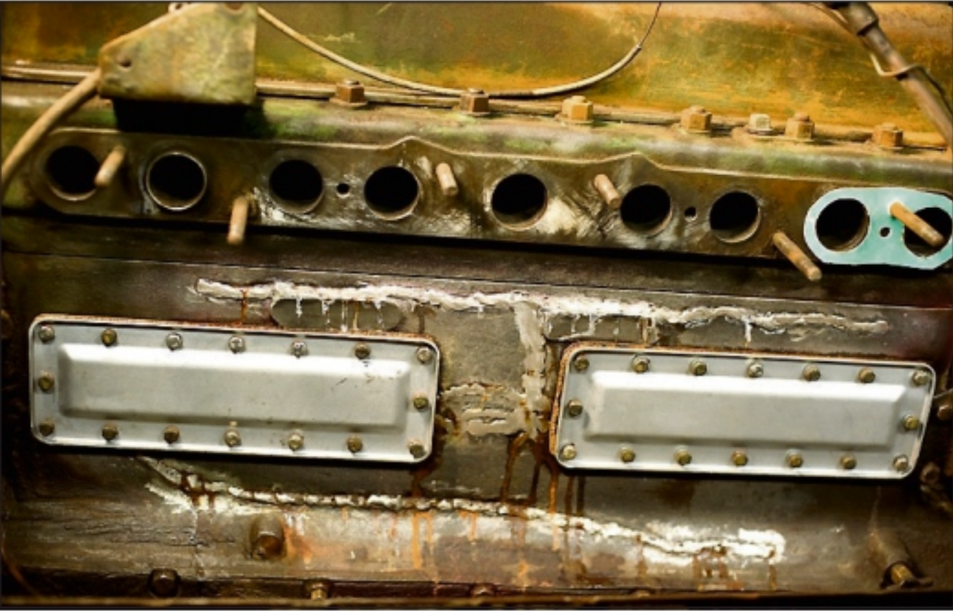
SPREKKER: På grunn av sprekker måtte motorblokken sveises.
